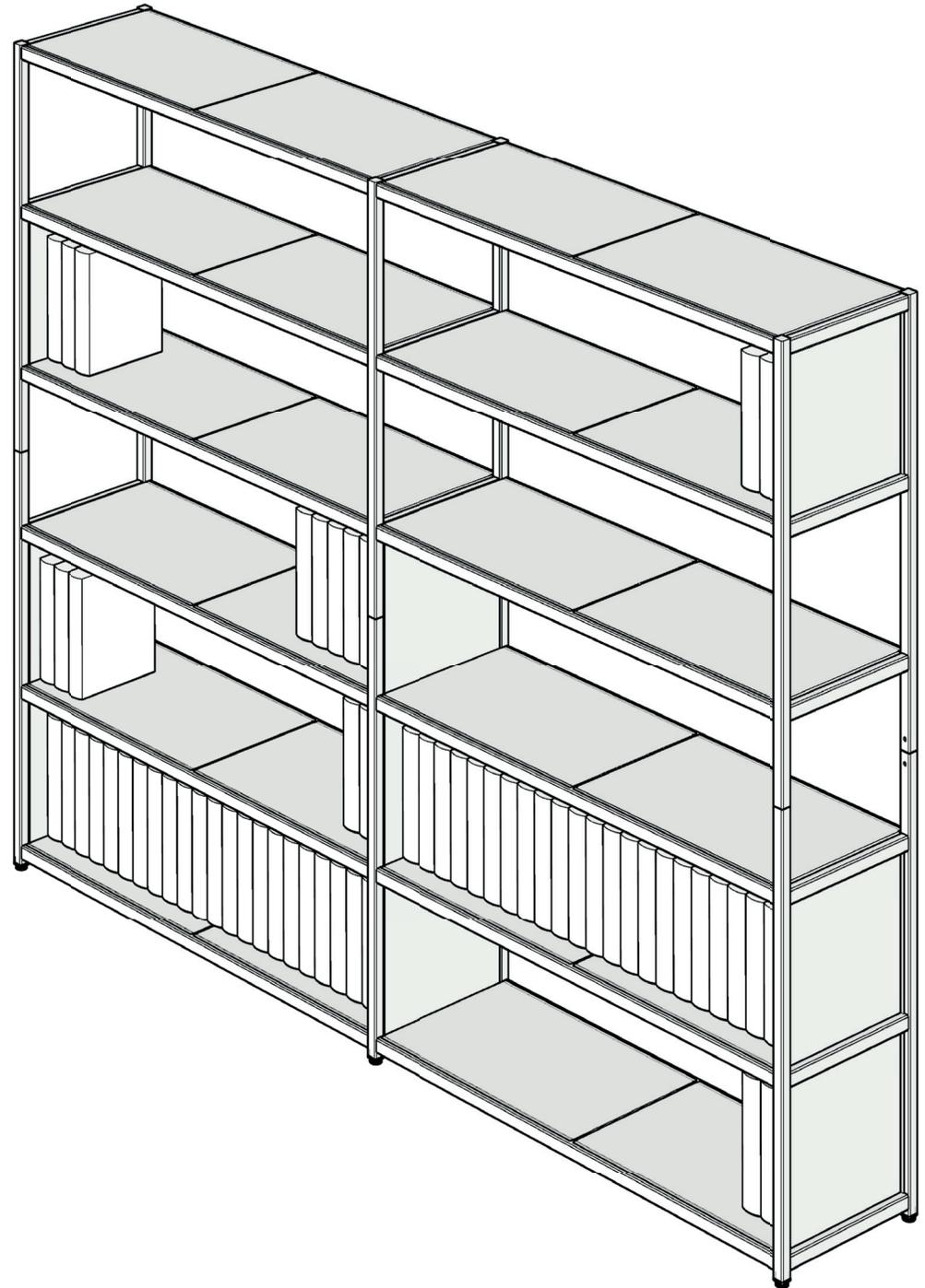
Buchstützen können je nach Bedarf auf beiden Seiten zwischen den Säulen eingesetzt werden.
